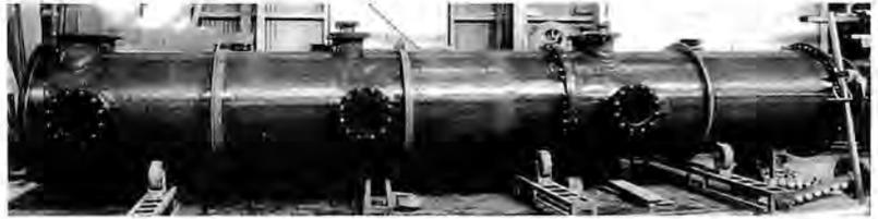
図6 HCl ガス除塵塔
