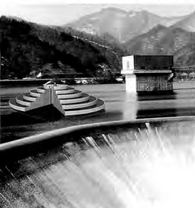
タワー」や「ミューグリーンリアクター」を組み込んだ水質浄化装置である。「ミューグリーンリアクター」を組み込む場合には水中に二重管を挿入し、エアリフト効果によって水の循環とマイクロバブルを生成させる。
