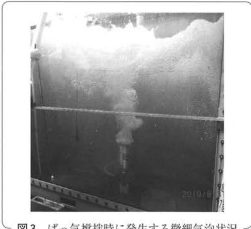
図3 ばっ気攪拌時に発生する微細気泡状況
