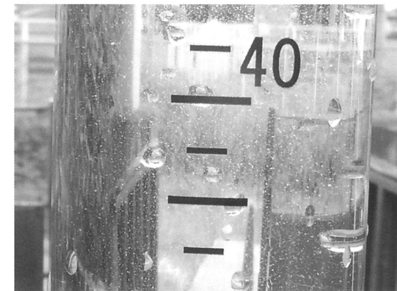
写真 9 【改修前】放流水のピンポイントフロック
